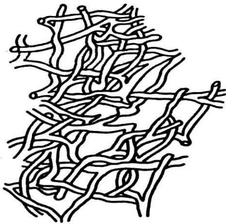
Рисунок 1.8 – Схема макроструктури дерми після лужного оброблення
