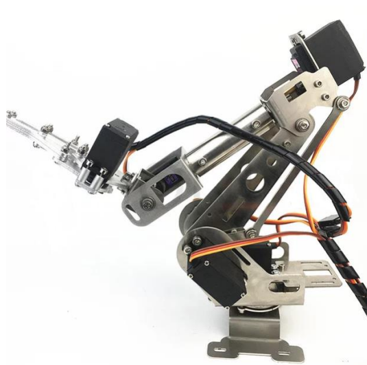
Рис. 2. Робот-маніпулятор з 6-ма ступенями свободи
