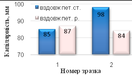
Рис. 3. Діаграми підняття рідини в структурі трикотажу на 60 хвилині дослідю
