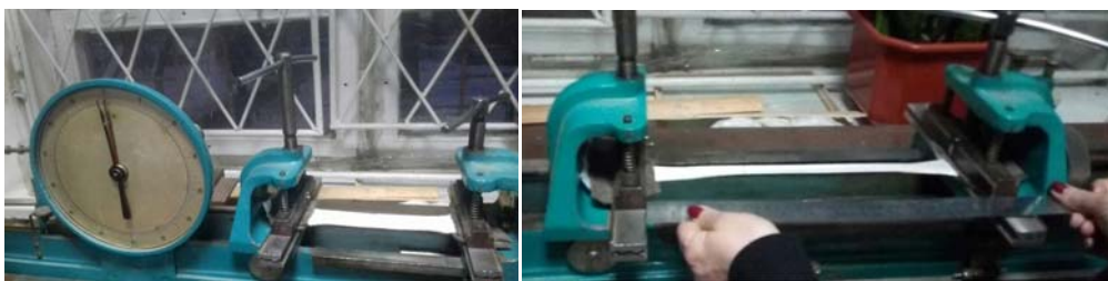
Рис. 2. Дослідження розривальних характеристик трикотажу
