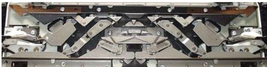
Рис. П.2.49. Голкові замки плосков'язальної машини (двосторонньої дії)
