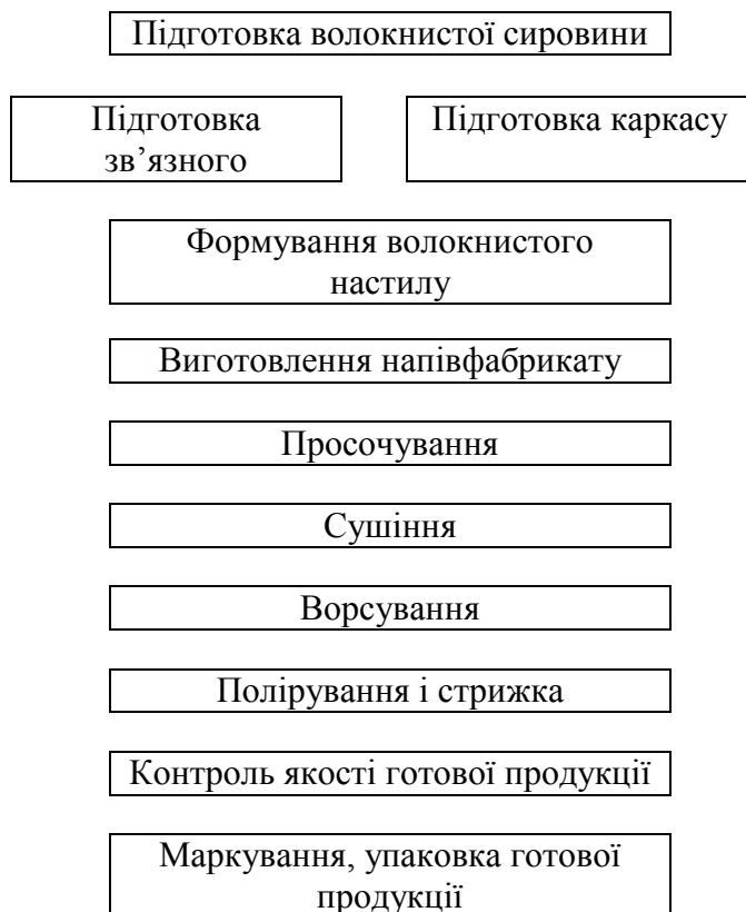
Рис. П.3.36. Схема технологічного процесу виготовлення НТМ типу штучного хутра способом «Вольтекс»
