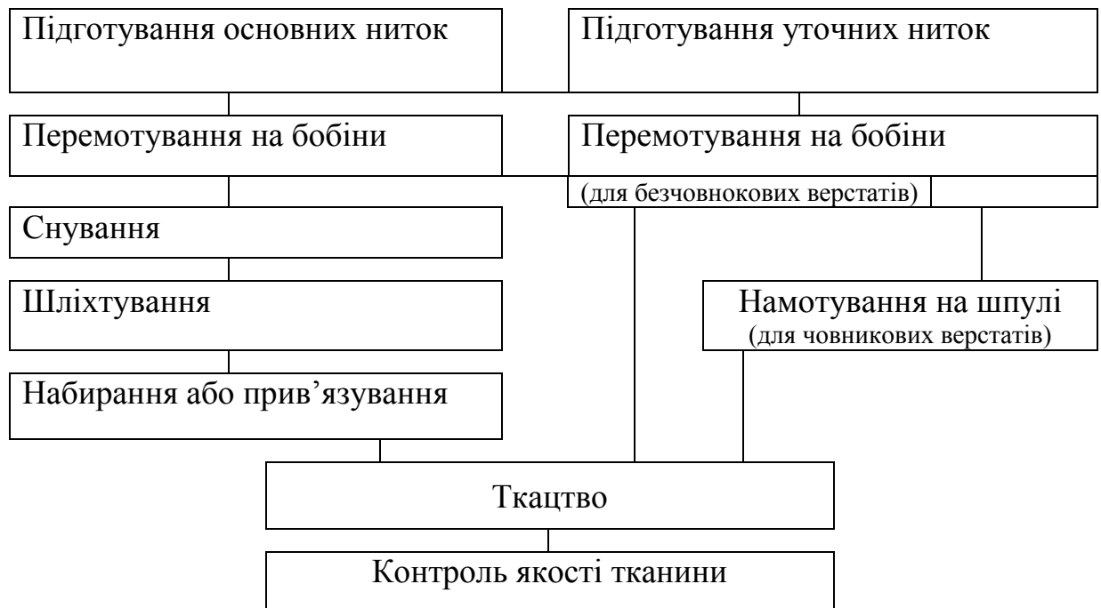
Рис. II.1.23. Загальна схема процесів ткацького виробництва
