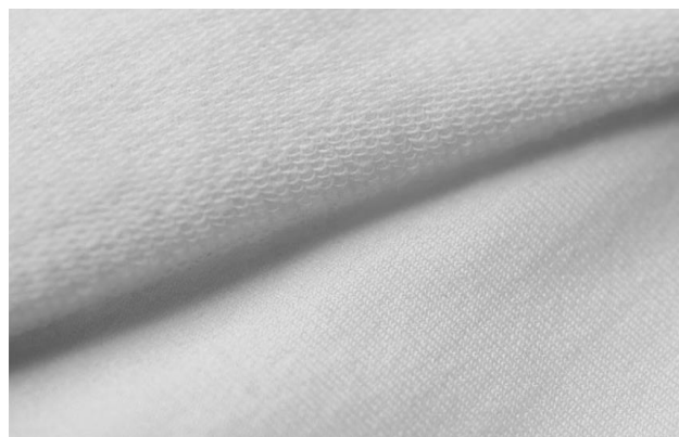
Рис. П.2.21. Футерований трикотаж
