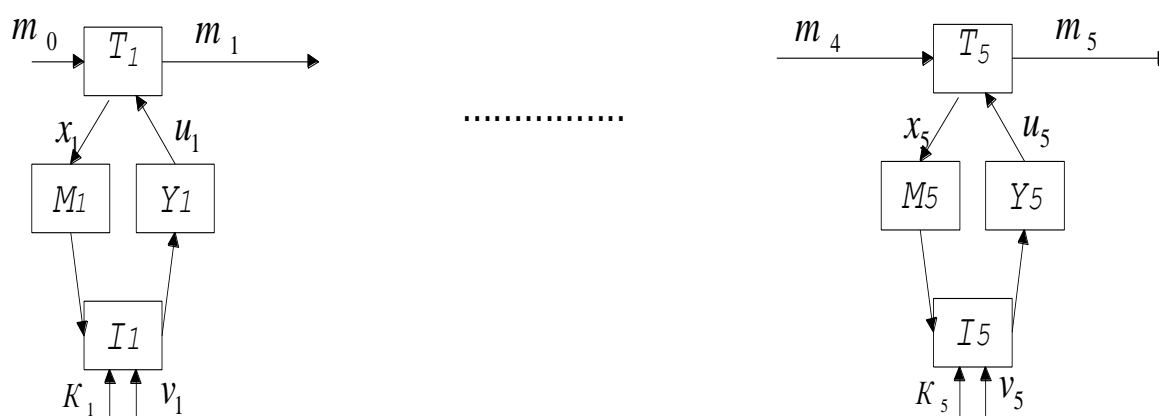
Рис. 2.6. Блок-схема зміни структури та властивостей волокнистого продукту в приготуванні чесаної стрічки (I частина прядильного виробництва)
