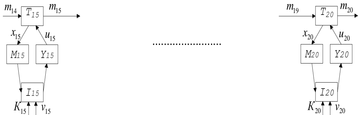
Рис. 2.8. Блок-схема зміни структури та властивостей волокнистого продукту в приготуванні рівниці та отриманні однопниткової пряжі (III частина прядильного виробництва)
