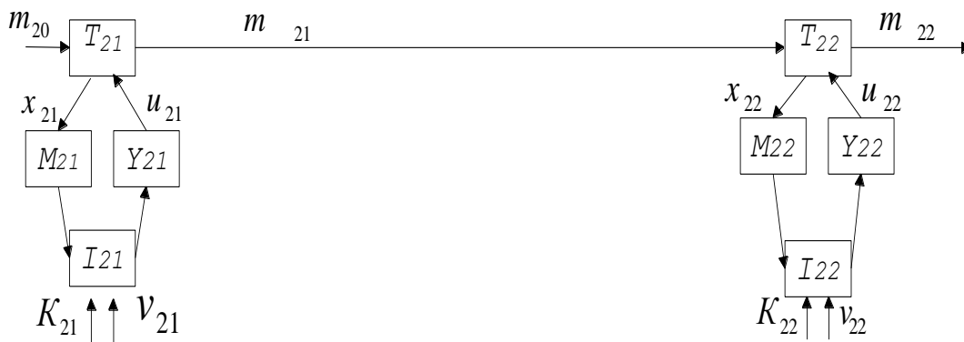
Рис. 2.9. Блок-схема виробничого перетворення властивостей вовняних тканин
